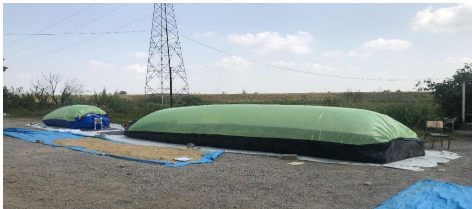
شکل ۱- خشک‌کن‌های تونلی خورشیدی نصب شده برای خشک کردن شالی در کنار مزرعه
